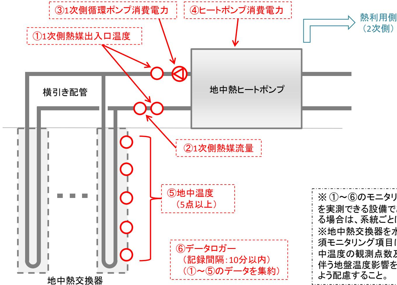
※①～⑥のモニタリング機器を備え、地中熱交換量を実測できる設備であること。(設備系統が複数になる場合は、系統ごとにモニタリングを実施すること。)
