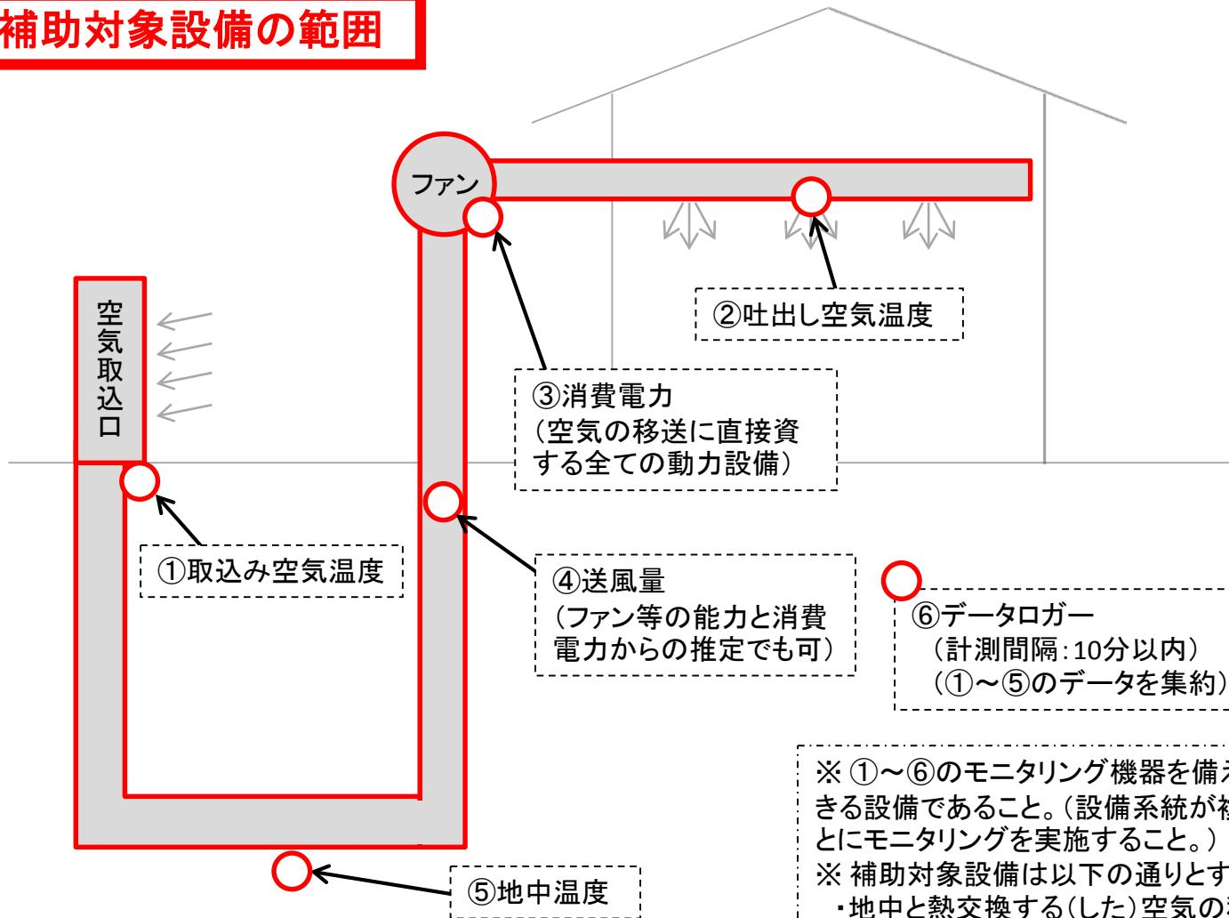
※①～⑥のモニタリング機器を備え、地中熱交換量を実測できる設備であること。(設備系統が複数になる場合は、系統ごとにモニタリングを実施すること。)
