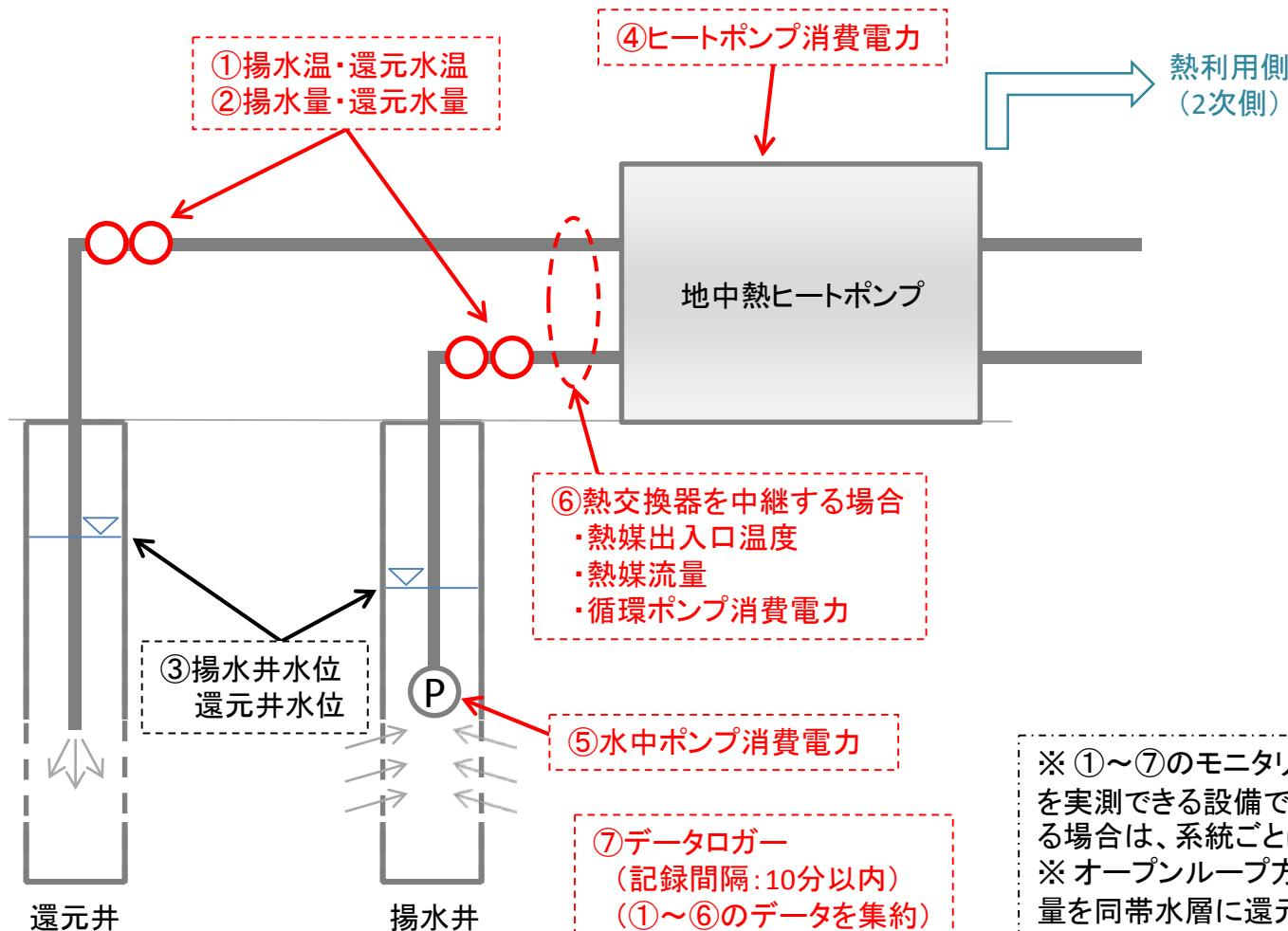
※①～⑦のモニタリング機器を備え、地中熱交換量を実測できる設備であること。(設備系統が複数になる場合は、系統ごとにモニタリングを実施すること。)
